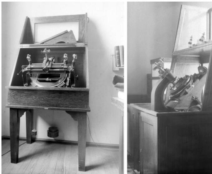
Máquinas de medir las placas del Catálogo Astrográfico del Observatorio Nacional Argentino.
