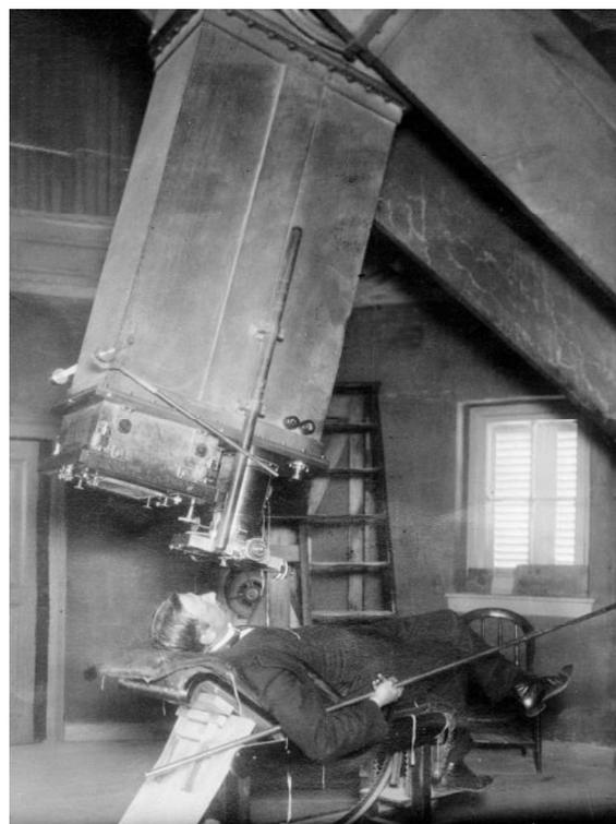
Telescopio Astrográfico del Observatorio Nacional Argentino, instalado en la cúpula de la primera sede de la institución. El fotógrafo Robert Winter muestra la posición de trabajo, en su mano derecha sostiene la barra que permitía adelantar o atrasar el telescopio en ascensión recta (Rev. Legado 05 07 AGN dep doc. fotog. 138290).
