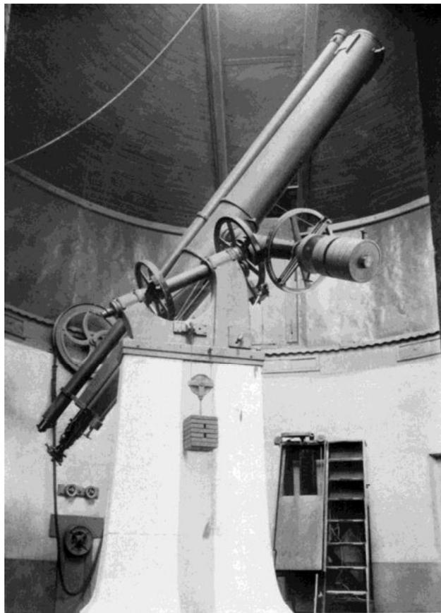
El Gran Ecuatorial, montado en la cúpula de la primera sede del Observatorio, a principios del siglo XX. La montura mostrada data de 1889 fabricada por Warner & Swasey. No se conservan imágenes de la montura original elaborada por Alvan Clark e Hijos.
